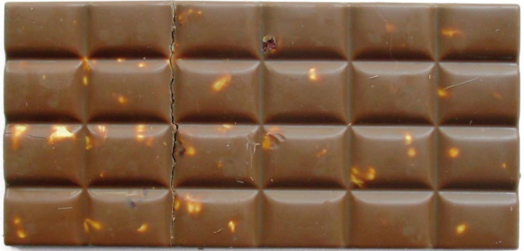
Abb. 2: Fehlerhafte Schokoladentafel mit Riss und unverschlossener Oberfläche.
