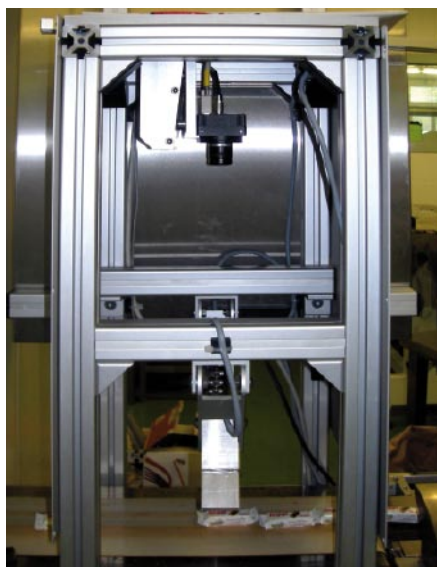
Abb. 1: Der Helms-Inspektor für verpackte und unverpackte Güter.
